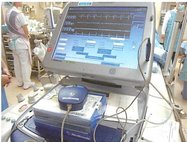
ペースメーカーは、右心室や右心房に留置したペーシングリードから電気刺激を送り、心臓を収縮させる装置です。ペースメーカー植込み手術を行う際、循環器内科医師の指示のもと、ペースメーカーシステムアナライザという持ち運び可能な装置を操作して、手術をサポートしております。
